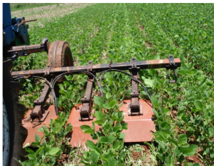
Figura 6. Campânulas de aplicação, dispostas em barra, acoplada perpendicularmente à parte central do trator.
