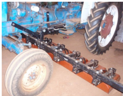
Figura 6. Campânulas de aplicação, dispostas em barra, acoplada perpendicularmente à parte central do trator.
