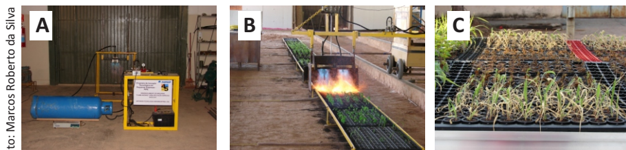
Figura 2. Aparato desenvolvido para pesquisa com flamejadores em laboratório financiado pela Agência Fapesp. (A) Avaliação de consumo de Gás LP dos queimadores; (B) Canteiro artificial para validação dos protótipos flamejadores, aplicando calor em diferentes espécies de plantas daninhas; (C) Detalhe do resultado da aplicação do calor sobre espécies estudadas.
