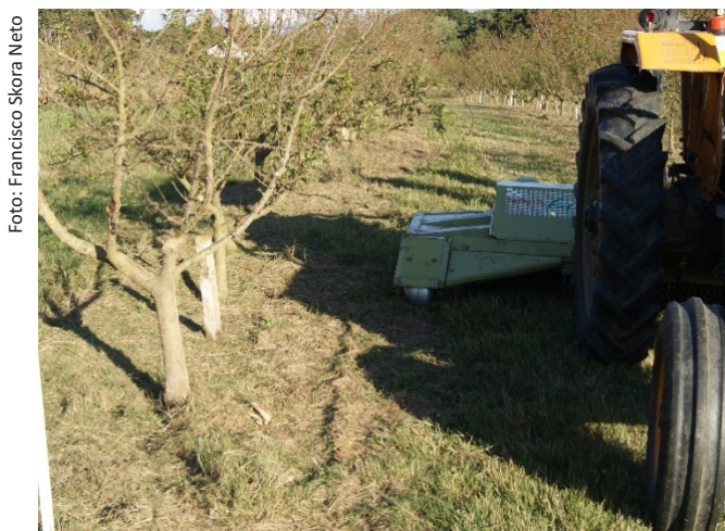
Figura 7. Roçadeira lateral, que joga o material roçado para a linha das plantas formando cobertura morta.
