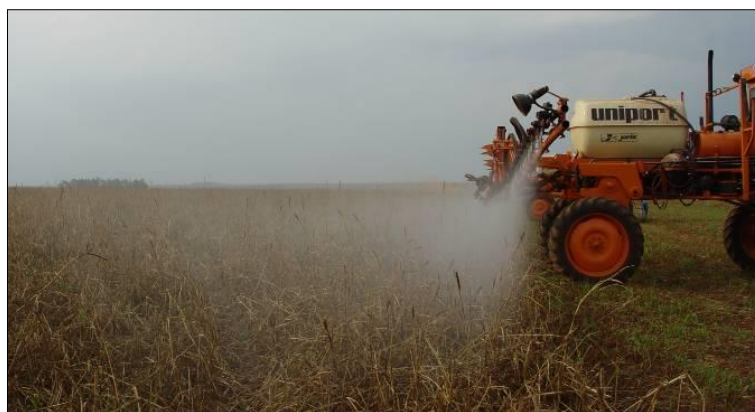
Figura 1. Deriva ocasionada pela produção de gotas de pequeno tamanho em condição ambiental desfavorável. Fonte: Marcelo C. Ferreira.
