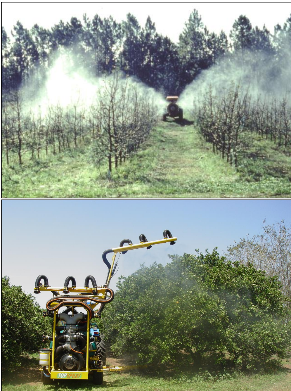
Figura 18. Ajustes no direcionamento do jato de pulverização para redução da deriva. Aplicação na cultura da maçã e pulverizador TopSpray. Fonte: Herbicat. Ltda. (2008)
