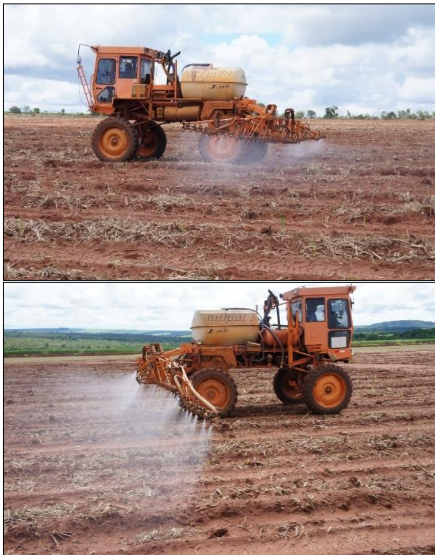
Figura 17. Deriva de acordo com o direcionamento do jato de pulverização. Fonte: Ferreira (2015).
