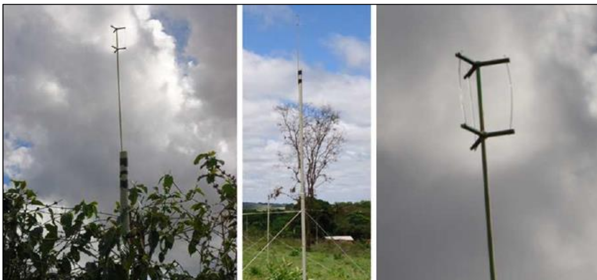
Figura 12. Coletores de deriva constituídos de fios de nylon, empregados para interceptar deriva em experimentos de campo. Fonte: LASMAR, 2014.
