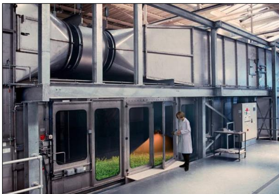
Figura 11. Túnel de vento instalado junto à Silsoe Spray Applications Unit, com as dimensões de 3 m (largura) x 2 m (altura) x 10 m (comprimento), operando em condições controladas, gerando velocidades de vento até 10 \text{ m s}^{-1} . Fonte: SSAU, 2017.
