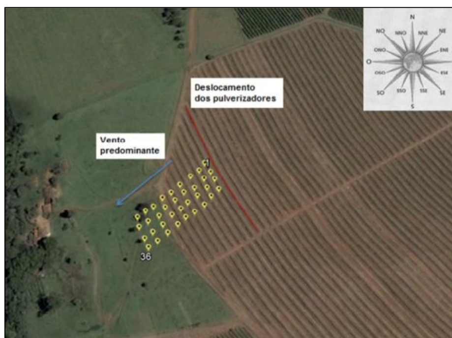
Figura 10. Distribuição de coletores em experimento conduzido à campo, para quantificar a deriva de pulverização. Fonte: LASMAR (2014).
