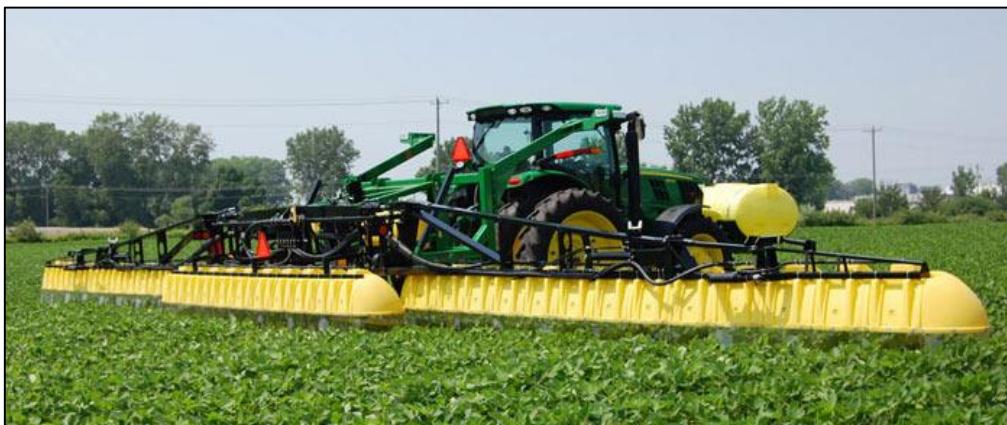
Figura 16. Direcionamento da aplicação com barra protegida para redução da deriva em pulverizações. Fonte: WILLMAR FABRICATION (2017).
