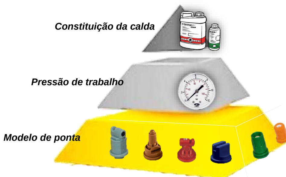
Figura 3. Esquema ilustrativo de importância no tamanho das gotas para modelo da ponta de pulverização, pressão de trabalho e constituição da calda. Fonte: Elaborado pelos autores.
