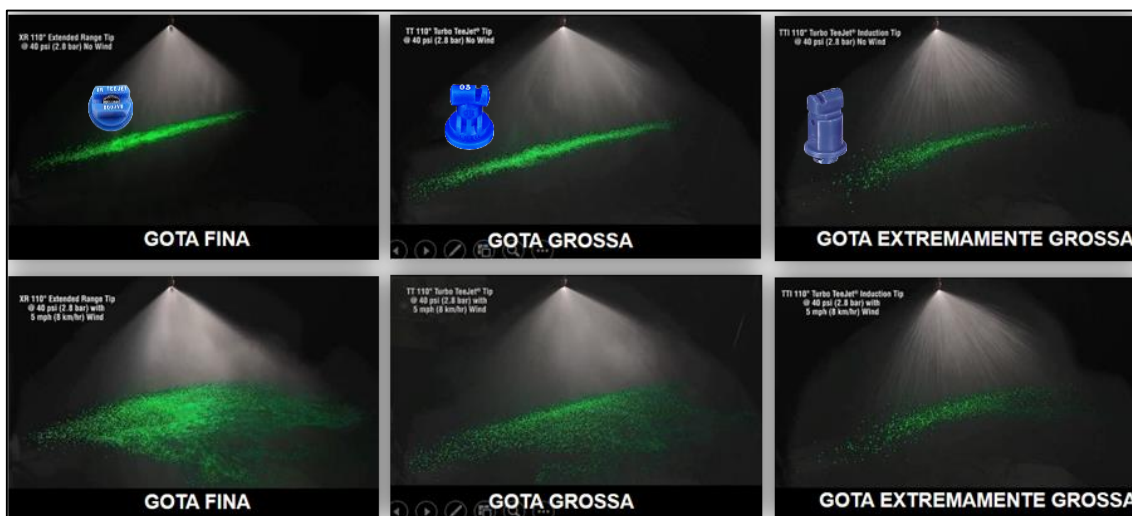
Figura 15. Ausência (linha superior) e presença (linha inferior) de vento na intensidade de 8 km/h, para pulverizações com três tamanhos de gotas distintos. Fonte: Teejet (2014).
