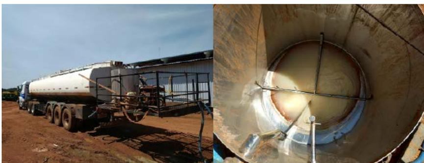
**Figura 25.** Sistema de preparo de caldas com pré-misturador em inox e com sistema de agitação.
