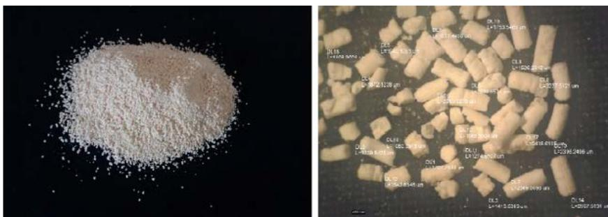
**Figura 9.** Herbicida WG com média do tamanho de partículas de 1.882 µm.
