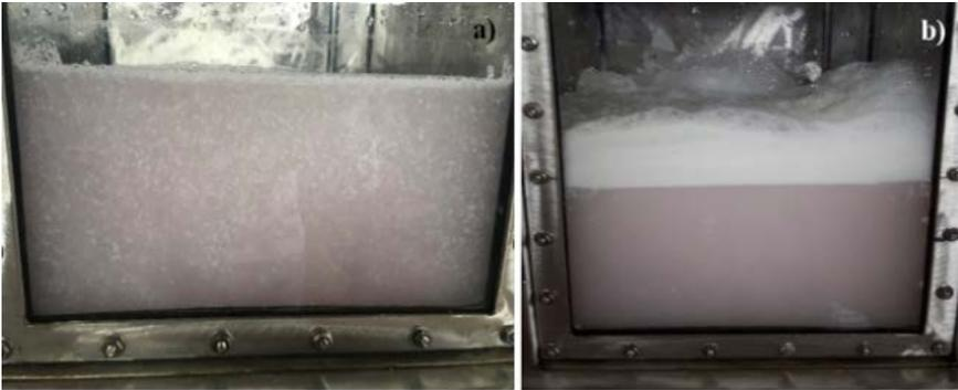
**Figura 21.** Caldas de pulverização sem agitação (a) e com agitação (b).
