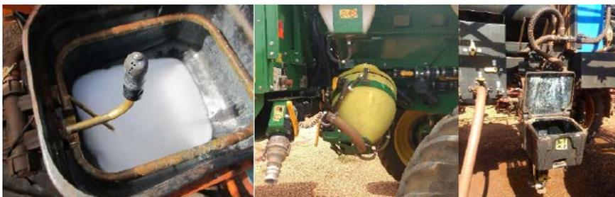
**Figura 23.** Modelos de incorporadores de calda que vêm de fábrica nos pulverizadores. Fonte: Oliveira (2018).
