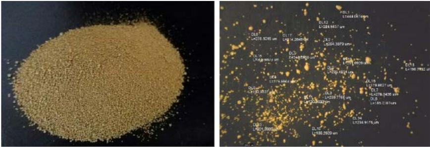
**Figura 10.** Herbicida WG com média do tamanho de partículas de 234 µm.
