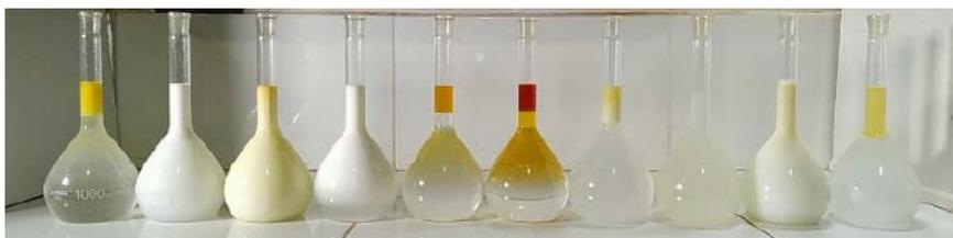
**Figura 4.** Exemplo clássico (água-óleo) de separação de fases de natureza química da mistura em tanque com diferentes óleos vegetais comercializados.
