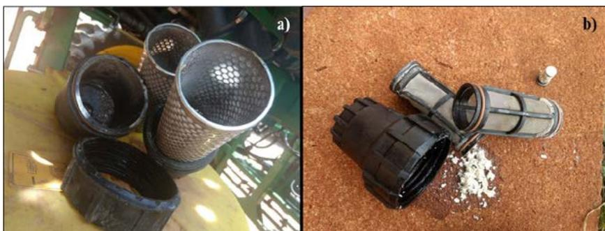
**Figura 15.** Resíduos de minerais de argila nos filtros de sucção (a) e incompatibilidade de herbicidas nos filtros de linha da barra de pulverização (b).
