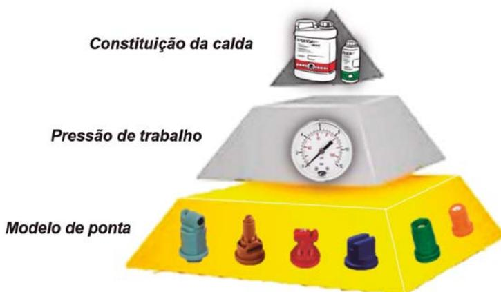
**Figura 2.** Esquema ilustrativo de importância no tamanho das gotas para modelo da ponta de pulverização, pressão de trabalho e constituição da calda (GRIESANG; FERREIRA, 2018).
