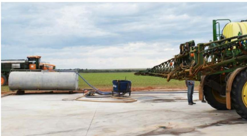
**Figura 26.** Pátio de apoio ao preparo de calda, sistema de pré-mistura e tanque de armazenagem de água limpa.
