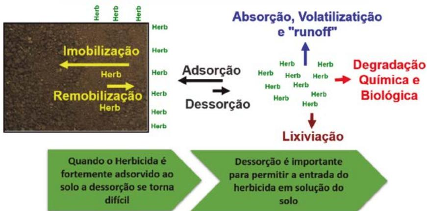
Figura 3: Dinâmica de Sorção e Dessorção de Herbicidas em Solos.
