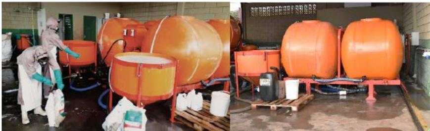
**Figura 26.** Sistema de calda concentrada, denominado pelo fabricante como “usina-gem de calda”.
