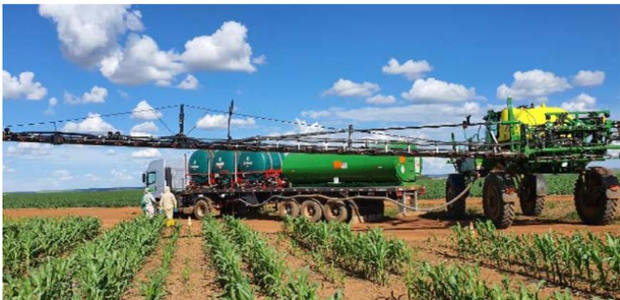
**Figura 27.** Operação do sistema de calda concentrada com três tanques de calda de produtos e um tanque de água limpa.
