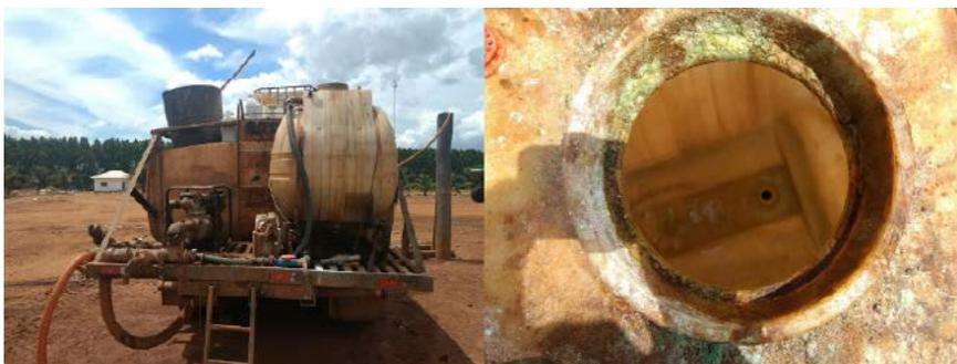
**Figura 24.** Sistema de preparo de caldas com pré-misturador em plástico e sem agitação.
